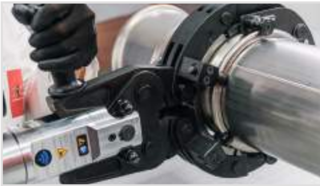
Assemblaggio pressatura n°2 / Press assembly phase 2
